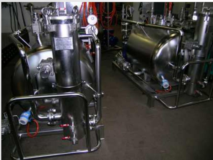
Module de base du système de nettoyage
